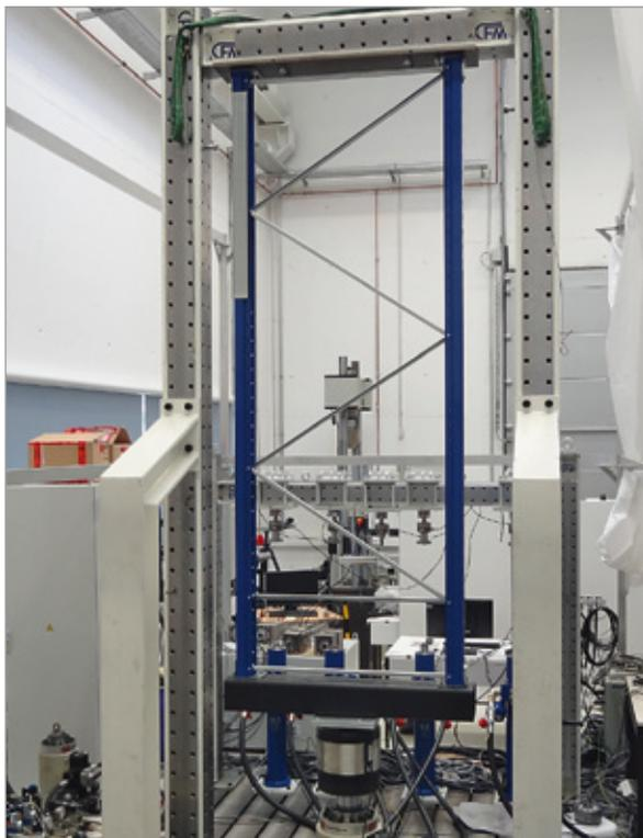
Testaufbau Palettenregalrahmen, gerichtet, mit Pfostenverstärkung, ca. 1000 mm Höhe, Material: 4 mm Stahlblech
